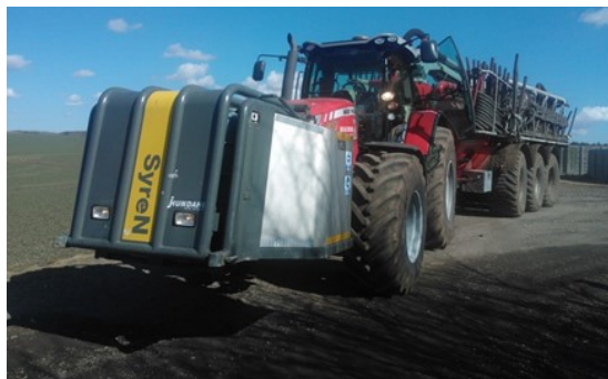
Billede 1. BioCovers SyreN+ system med frontmonteret syretank og indbygget ammoniakbeholder i gyllevognen. Foto: Annette Vibeke Vestergaard, Videncentret for Landbrug.
